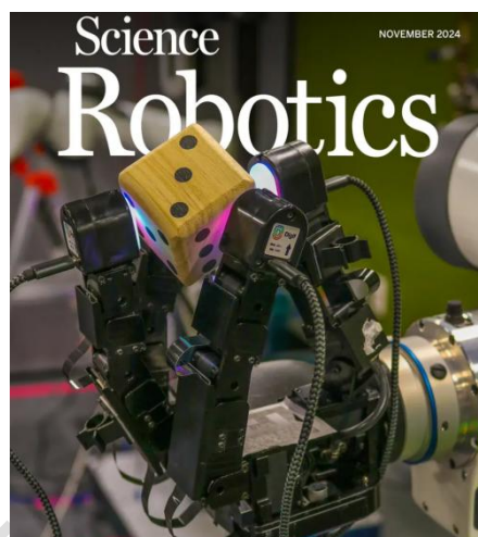
图 2.11 Meta FAIR 团队研发的视触融合的机械手臂，数据来源：
