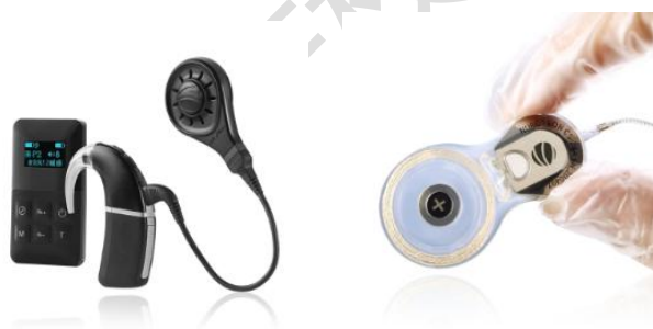
图 2.8 voyager（远航）人工耳蜗系统和 CS-20A 植入体，图片来源：诺尔康官网
