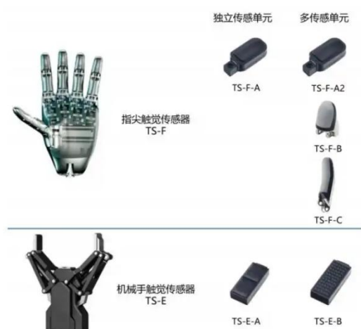
图 2.10 指尖触觉传感器，图片来源：他山科技
